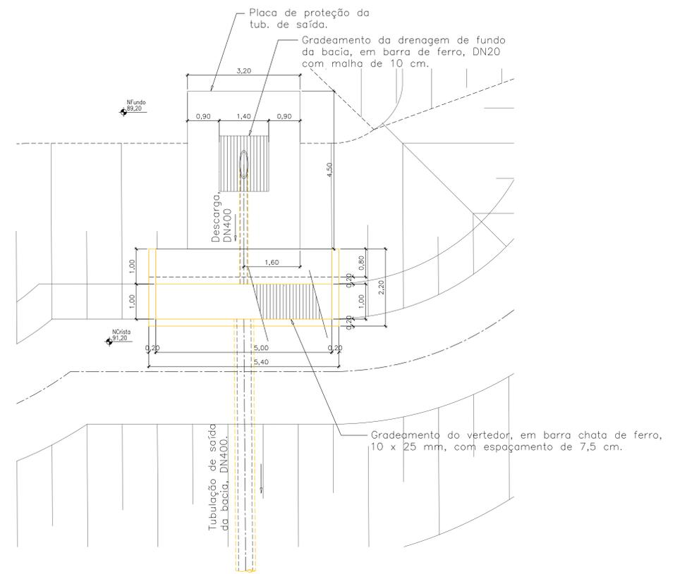
PLANTA TÍPICA DA ESTRUTURA DE INTERLIÇÃO DAS LAGOAS (SAÍDA DA LAGOA - 13A E ENTRADA DA LAGOA - 13B)
